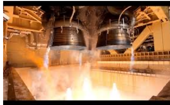
H3の燃焼試験@種子島
