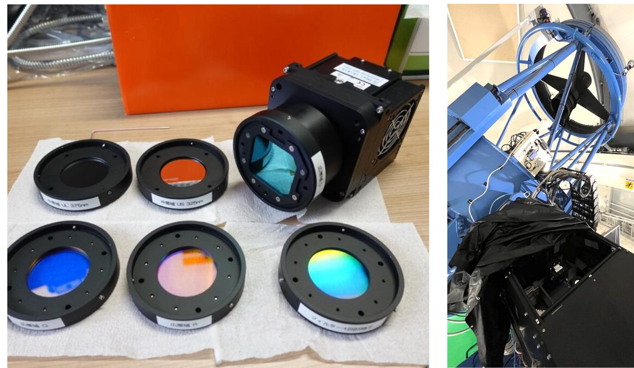
(左)撮像装置, (右)かなた望遠鏡における試験観測
