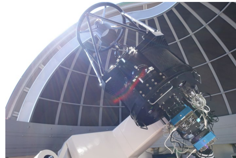
HinOTORI 50cm鏡 可視3色同時カメラ 視野24分角 □ u' , Rc , Ic
