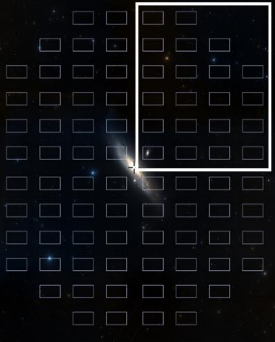
Tomo-e Gozenカメラと狭帯域フィルター。 84枚のチップで構成があり、一度に20平方度の領域を撮影できる。 6/16
