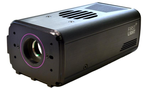
サイエンス用赤外カメラ FIRST LIGHT C-RED2 (InGaAs) 640x512 pix 15um pitch 最大600FPS RON < 30e- 水冷+ペルチエ: -40°C
